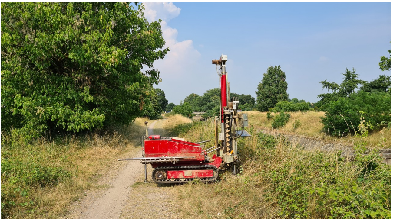
Figura B. 2 - Indagine Penetrometrica DPSH2.
