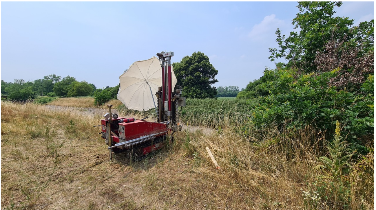
Figura B. 4 - Indagine Penetrometrica DPSH4.
