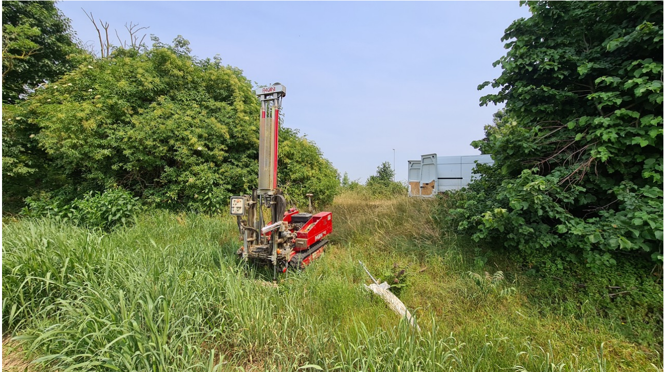
Figura B. 1 - Indagine penetrometrica CPT1.
