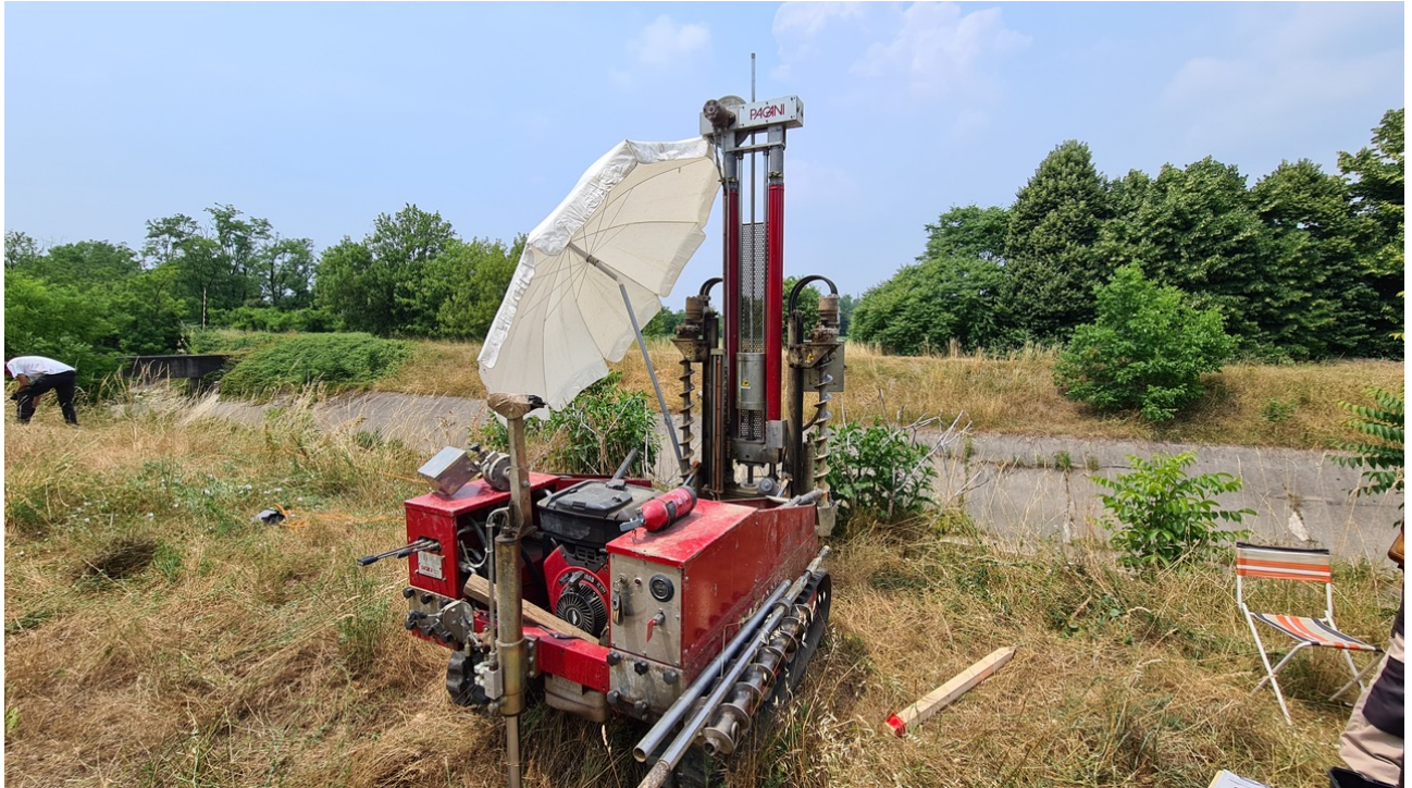
Figura B. 5 - Indagine Penetrometrica DPSH5.
