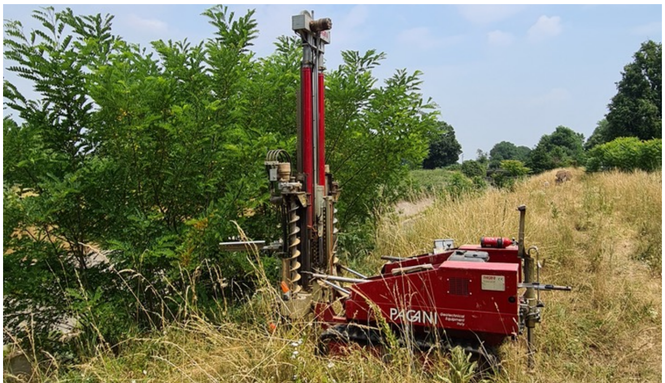
Figura B. 6 - Indagine Penetrometrica DPSH6.
