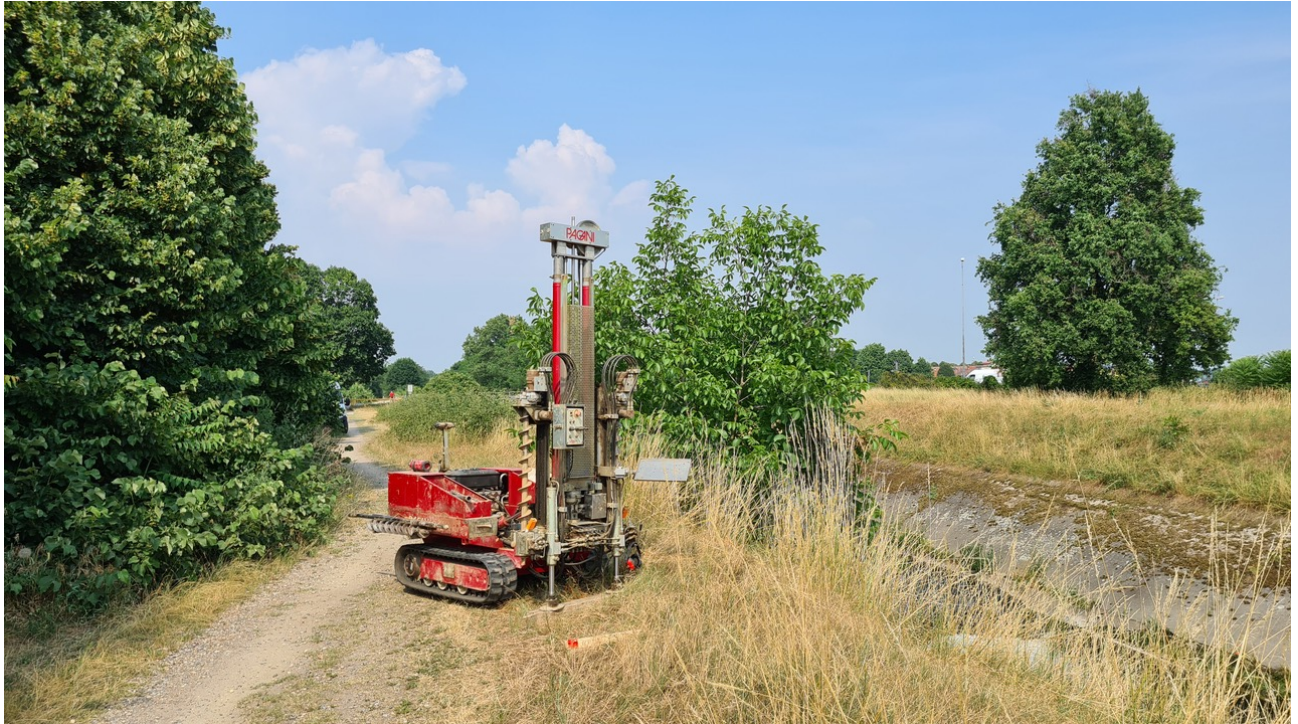
Figura B. 3 - Indagine Penetrometrica DPSH3.
